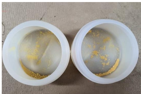
Figura 2. Partículas de sílice mesoporosa cargados con aceites esenciales.
