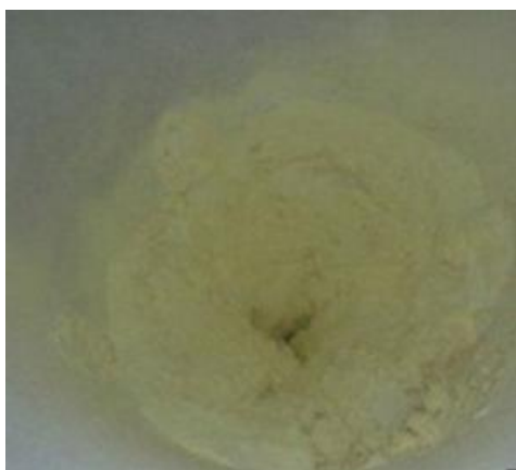
Figura 1. Apariencia del suero deshidratado por aspersión. Se utilizó un secador Spray dryer debido a sus características que garantizan la uniformidad en el tamaño de partícula del producto (malla 40). Muestra representativa.
